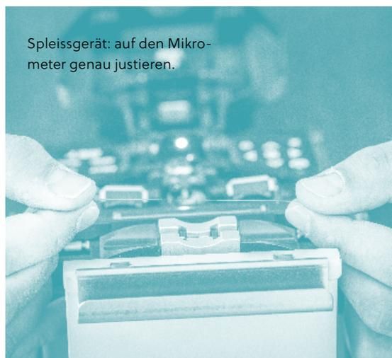
Spleissgerät: auf den Mikrometer genau justieren.
