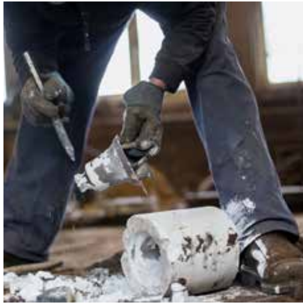
Ein Klangkörper entsteht: Der Glockenkern und die falsche Glocke bilden einen Hohlraum, in den die flüssige Bronze läuft. Nach dem Guss wird die Glocke – hier ein privates Geschenk – aus der Form befreit und in der Werkstatt bearbeitet.
